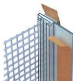
**Anputz-Leiste mit Armierungsgewebe (165 g).** Profil in 6 mm und 9 mm Stärke. Gewebeschenkel 10 cm aus geprüftem VWS-Gewebe. PE-Band mit Prüfung auf Schlagregendichtigkeit.
